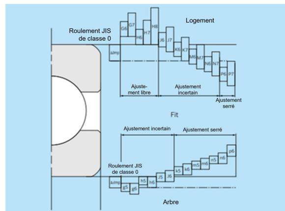
*Lors du choix de l'ajustement, il faut toujours jeter un coup d'œil sur les conditions de fonctionnement (en particulier l'influence des variations de température et les charges des roulements).*
