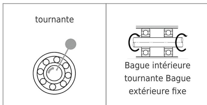
Charge radiale et ajustement du roulement : vous voyez ici la relation entre le type de charge et l'ajustement du roulement.
