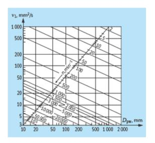
Calcul de la viscosité de référence  $v_1$  au moyen d'un diagramme.
