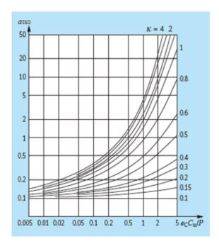
De haut en bas et de gauche à droite, vous trouverez des indications sur le coefficient de durée de vie  $a_{ISO}$  des roulements à billes radiaux, des roulements à rouleaux radiaux, des
