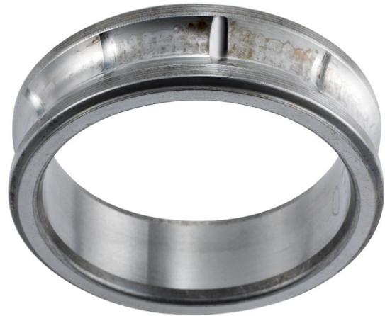
*Exemple de cette bague de roulement montrant des marques de faux effet Brinell. Celles-ci ont été causées par des vibrations lors d'un arrêt du roulement.*
