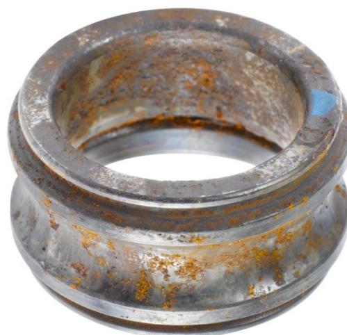
*Bague d'un roulement à billes à gorge profonde touchée par la corrosion sous forme de rouille, provoquée par la pénétration de fluides corrosifs comme l'eau dans le roulement.*
