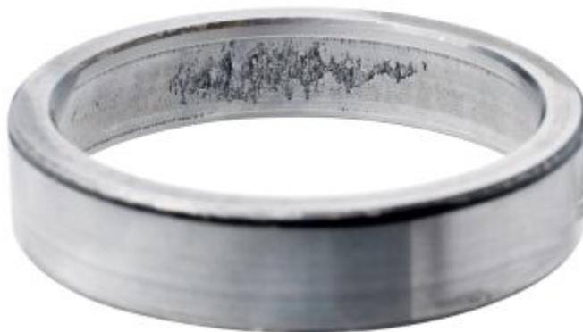
*Sur cette bague de roulement, on peut voir un écaillage en profondeur partant de la surface. L'écaillage est par exemple dû à des particules étrangères dans le lubrifiant. Ecrasées par les corps roulants, elles peuvent entraîner des dommages ultérieurs au roulement.*
