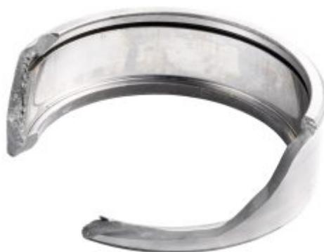
*Cet exemple de rupture de bague sur ce **roulement à rouleaux cylindriques**, peut être due à des chocs, à une surcharge ou à de la flexion.*
