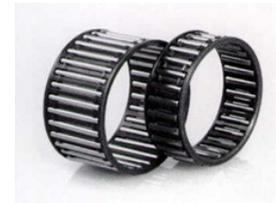
*Il semble que la fabrication du roulement ne soit pas encore terminée. Mais en réalité, dans les cages à aiguilles, l'arbre et l'alésage du logement servent de chemins de roulement.*
