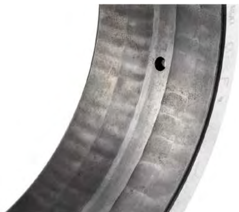
Cet exemple montre un ponçage du matériau sur la surface du chemin de roulement .
