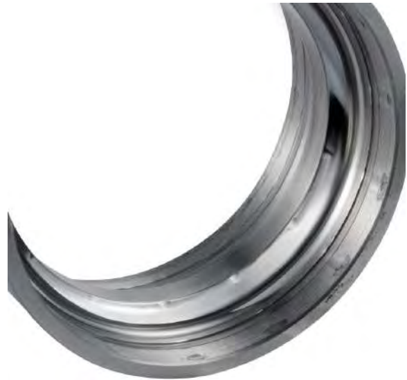
Ici, des déformations sont visibles sur la bague de roulement.
