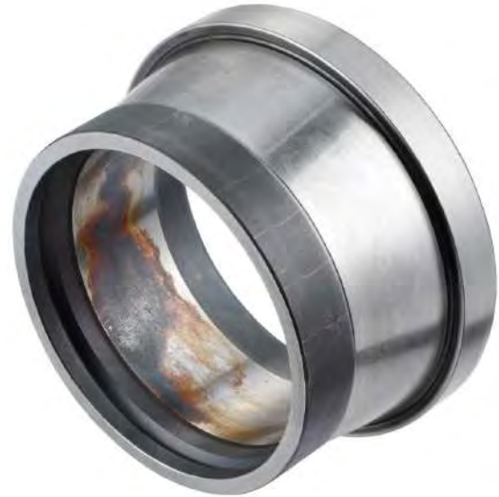
Cette bague intérieure est affectée par la corrosion de contact.
